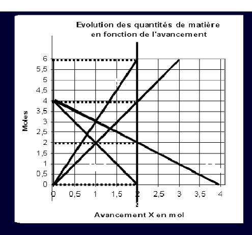
$H_2S$  et  $SO_2$  sont des réactifs donc les droites décroisse.  $H_2S$  disparaît plus vite que  $SO_2$  donc la droite représentant  $H_2S$  décroît plus vite.
