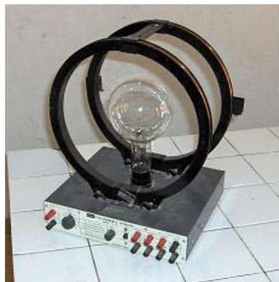
Tube à gaz raréfié pour la mesure de  $e/m$
